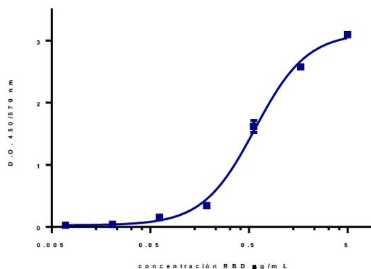
Unión de un anticuerpo neutralizante anti-RBD a SPIKE-RBD VARIANTE DELTA (PRBD-0-D1) en un intervalo de concentración de 0.007 – 5 µg/mL por ELISA.
